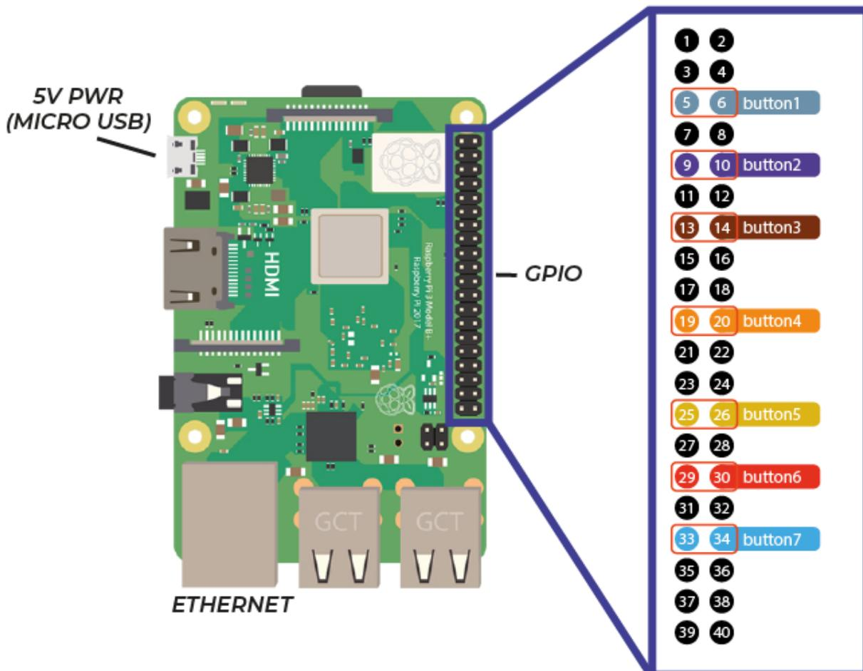
**You can connect the button(s) to the pin pairs of the GPIO pin marked on the diagram. (5;6), (9;10), (14;15), (19;20), (25;26), (29;30), (33;34).**
